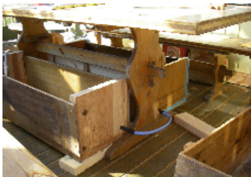
反対側はホースでつながっているので、お湯が循環する。
